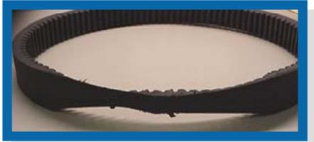
Износ ремня отдельными пятнами – распространённая проблема. При попадании вытертого пятна на шкивы может быть слышен характерный звук. Пятна вытирания обычно образуются на ведущем шкиве.
