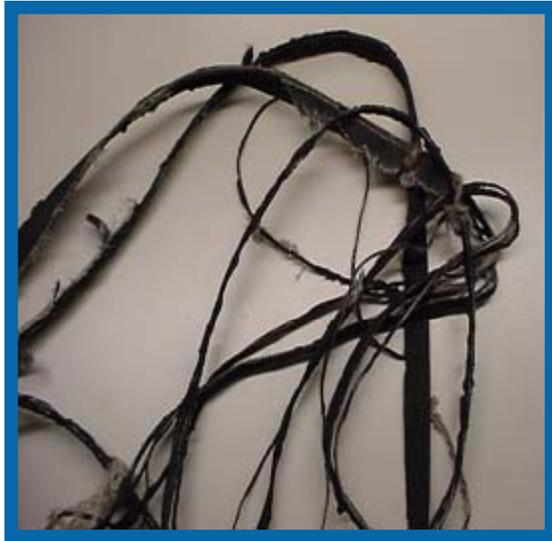
Расщепление ремня происходит из-за интенсивной работы или нехватки ухода. Поэтому перед выездом нужно осмотреть приводной ремень, обнаружить отделившийся корд, трещины или разрывы.
