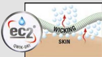
Выше схематично показано, как новая ткань ec2® Qwik-Dri отводит тепло и влагу благодаря воздействию электростатических сил, видоизменяющих структуру волокон, слагающих ткань. Процесс отведения пота и тепла более активен, что позволяет его обладателю оставаться сухим не подвергнуться перегреванию даже во время интенсивной работы, сопровождающейся потоотделением и выделением большого количества тепловой энергии.
