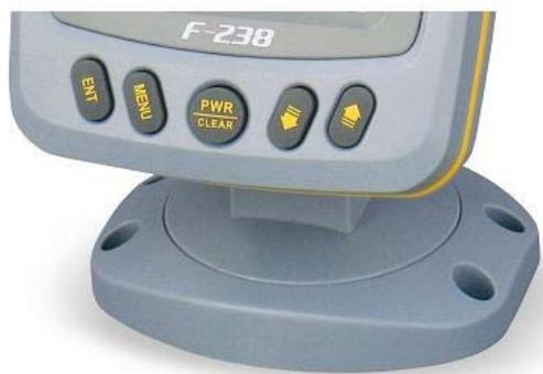
Всё управление эхолотом можно выполнить с помощью пяти клавиш на его передней панели. При нажатии клавиши эхолот издаёт звуковой сигнал, подтверждая тем самым исполнение команды, закрепленной за этой клавишей.
