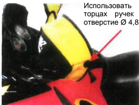
Использовать отверстия на торцах ручек или высверлить отверстие  $\varnothing$  4,8 мм. Как показано, установить комплектные шпильки. «Липучку» склеить или загнуть по месту.
