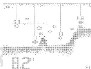
Функция ID+ (“усовершенствованное обнаружение”) позволяет придать дополнительную информацию объекту, обнаруженному в воде, что может помочь правильно обнаружить рыбу. Когда эта функция включена, около символа рыбы на экране появится цифра, обозначающая глубину по вертикали до обнаруженной рыбы.
