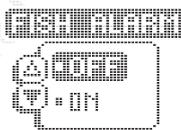
Заводская настройка этой функции - "Выключено" (OFF). Если выбрать сигнальный символ "одна рыба", сигнализация сработает только при обнаружении рыбы большого размера. Если выбран сигнальный символ "две рыбы", сигнализация сработает при обнаружении рыбы среднего и большого размера. Если установить сигнальный символ "три рыбы", сигнал зазвучит при обнаружении эхолотом рыбы любого размера.
