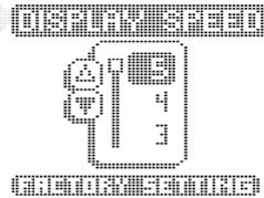
Выбор требуемого значения скорости обновления экрана выполняется кнопками со стрелками. При выключении эхолота установленное значение скорости обновления экрана сохраняется в памяти прибора.
