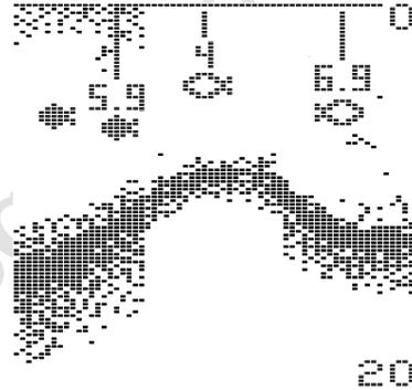
**Рябь (Surface Clutter).** "Рябь" - это изображение, которое получается на экране около линии поверхности воды в случае волнения, когда приповерхностная тоща воды насыщается пузырьками воздуха. Звуковые волны, проходя сквозь эти слои воды, искажаются, рассеиваются около линии поверхности воды на глубине 0.
