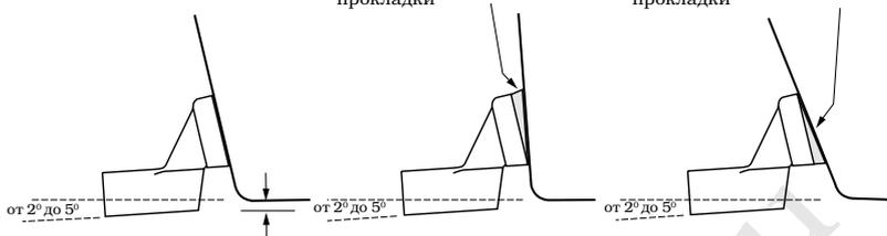
Для стеклопластикового днища - зазор 3.2-6 мм
