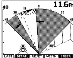
Большая вращающаяся ручка на корпусе эхолота с надписью “BEAM” (Луч) может использоваться для настройки ширины сканирующего луча и направления, в котором производится сканирование. К примеру, может появиться необходимость сканировать область только по правому борту (старборт), или по левому борту (штурборт).
