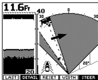
При нажатии программной кнопки STEER (Направление) (см. рис.) луч будет переключаться в пределах 90° возможного сектора обзора.
