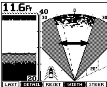
Большая вращающаяся ручка на корпусе эхолота с надписью “BEAM” (Луч) может использоваться для настройки ширины сканирующего луча и направления, в котором производится сканирование. К примеру, может появиться необходимость сканировать область только по правому борту (старборт), или по левому борту (штриборт).
