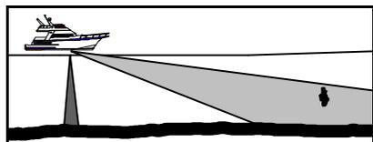
Плоскость сектора, занимаемого зондирующим лучом, наклонена под углом  $20^\circ$  к поверхности воды. Луч коснется дна при дальности, примерно в 3-3,5 раза большей глубины
