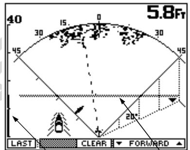
Для отмены ранее установленных настроек зоны сигнализации нажмите программную кнопку CLEAR (Очистка). Такое же действие можно произвести вращением ручки “BEAM” по часовой стрелке до тех пор, пока вертикальная полоска на шкале расстояний (слева на экране) не уменьшится до нуля.
