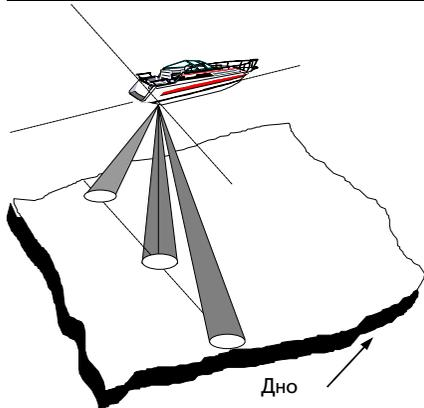
Луч шириной  $12^\circ$  может быть направлен в любом направлении в пределах сектора  $90^\circ$
