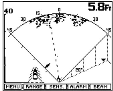
Хотя автоматическая настройка чувствительности в основном работает неплохо в наиболее общих условиях, следует прибегать к ручной настройке чувствительности для решения конкретных задач.
