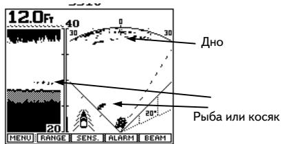
На рисунках в нижней части стр. 45 следует обратить внимание, что даже на мелководных участках (12 футов = 3,6 м) "Sea Scout" способен нормально отобразить плавающий в воде объект на расстоянии до 200 футов (60 м). В таких случаях следует выполнить ручную настройку чувствительности. В противном случае режим автонастройки уменьшит чувствительность приемника, чтобы компенсировать сильное эхо, приходящее от близко расположенного дна.
