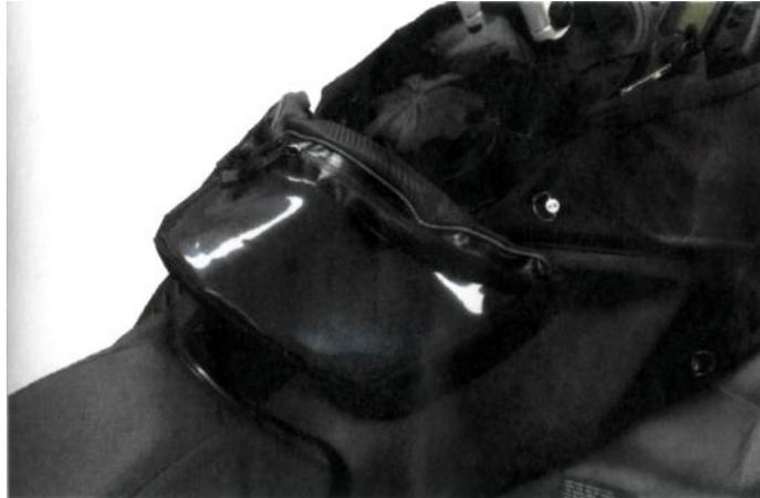
**Место для приклеивания «липучки» нужно очистить спиртом. Для приклеивания «липучки» нужна температура не ниже 13°C в течение 12 часов подряд.**
