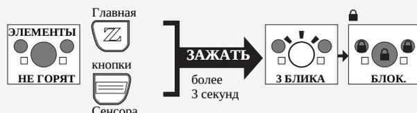
При снятии блокировки главный элемент мигнёт 3 раза
